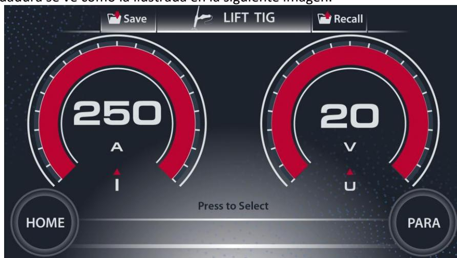
3. Mediante la perilla **(02)** seleccione un valor adecuado de corriente de soldadura, dependiendo del tipo y espesor del material a soldar.
