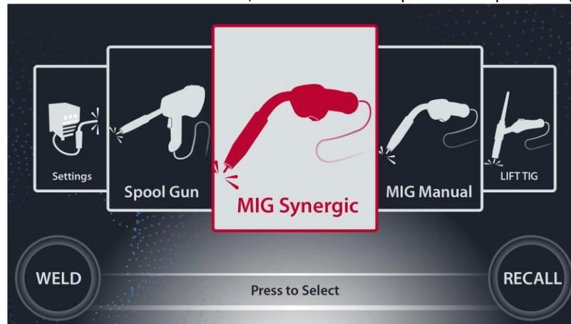
En este menú se podrá seleccionar el modo de operación de la máquina. Para moverse entre las distintas opciones, se debe utilizar el encoder (06). Para seleccionar una debemos apretar el encoder (06). Las opciones a elegir en este menú son:
